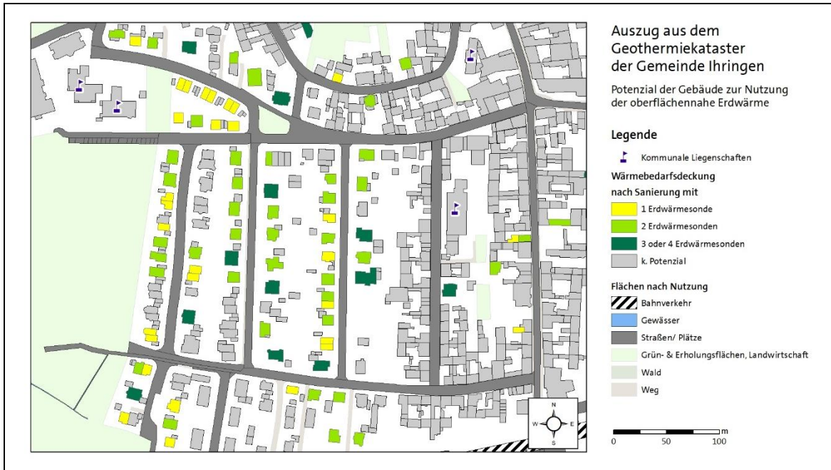
Abbildung 34 – Ausschnitt des Geothermiekatasters (technisch-ökonomisches Potenzial), Ihringen
